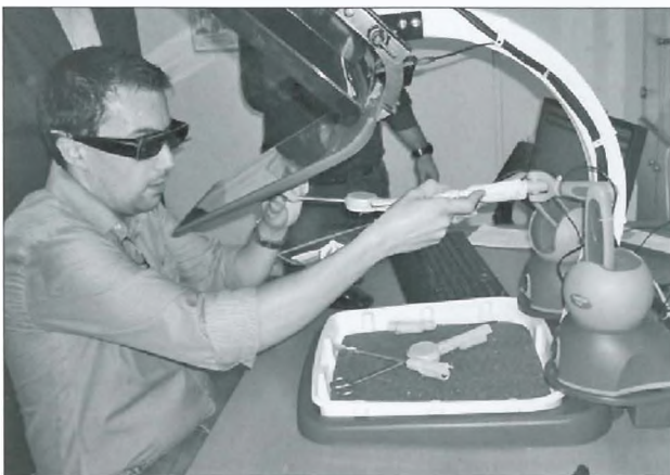
Προσομοιωτής (HAPTIC 3D) για εκπαίδευση στην εισαγωγή ενδομητρικού σπειράματος
