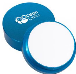
Σχήμα 4: Φωτογραφία από την επιφάνεια του Spectralon που χρησιμοποιείται για τη βαθμονόμηση των φασμάτων ανάκλασης.
