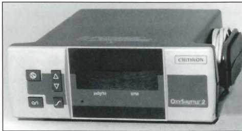
Εικ. 1. Δείγμα παλμικού οξύμετρου κατάλληλου για νεογνά.
