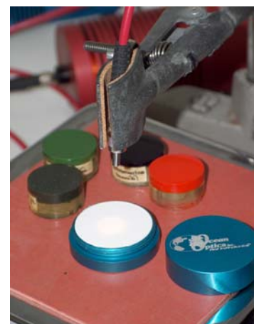
Εικόνα 3.: Φωτογραφία από την ανάκλαση φωτός στην επιφάνεια του στάνταρτ Spectralon που χρησιμοποιείται για τη βαθμονόμηση του φάσματος ανάκλασης.
